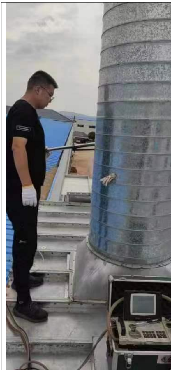
有组织废气采样1（南面木工车间木工粉尘） DA001
