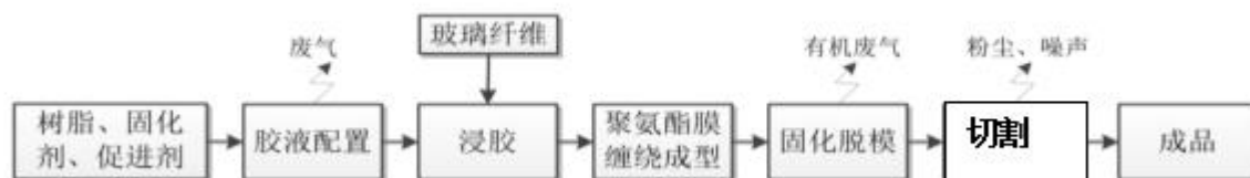
图2-2 实际玻璃钢管生产工艺流程及产污节点图
