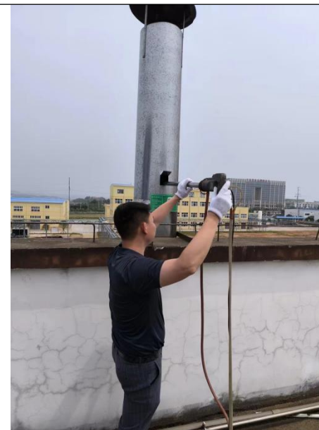
3#车间喷雾干燥粉尘排气筒DA005采样
